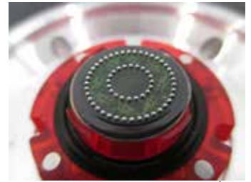
ตัวอย่างอิเล็กทรอนิกส์ชิพแพคเกจที่ผลิตโดย Minimal Fab
