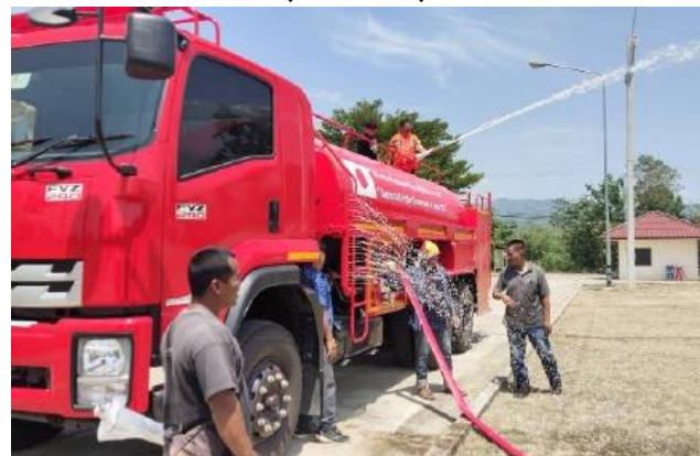
ฟังก์ชันสเปรย์น้ำเพื่อการดับเพลิง
